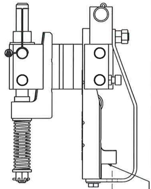
Freisparung für Kopplungsgestänge
